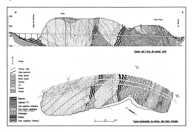
Figure 11. Coupes géologiques verticale et horizontale par les tunnels autoroutiers de Glion.
