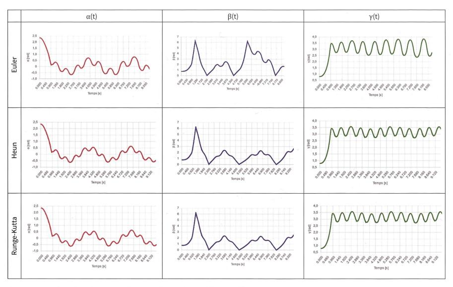
Figure 3. Variation des angles  $\alpha$ ,  $\beta$  et  $\gamma$  au cours du temps, en fonction des trois différentes méthodes d'intégration (Euler = 1<sup>er</sup> ordre; Heun = 2<sup>e</sup> ordre; Runge-Kutta = 4<sup>e</sup> ordre).
