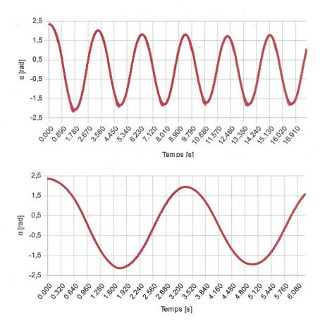
**Figure 2.** Graphique de l'angle  $\alpha$  (pivot) avec la fronde et la longueur du contrepoids tendant vers zéro (0,01 m). Le graphe en bas est un grossissement de celui en haut pour la période entre 0 et 6 secondes.
