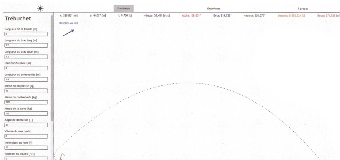
Figure 1. Simulation d'un tir de trébuchet sur notre site : www.trebuket.org . Les paramètres du tir peuvent être modifié dans la colonne de gauche, et les résultats du tir sont visibles dans les onglets de haut de page « Simulation » et « Graphiques ».
