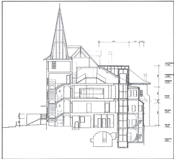
Figure 8. Une coupe transversale montre l'organisation et accès aux étages ici dénommés -rez inf., rez sup., étage et combles (ACV). Un escalier en colimaçon permet, depuis l'entrée à la rue Saint-Etienne no 7, l'accès aux étages inférieurs, avec l'auditoire, les collections et expositions.
