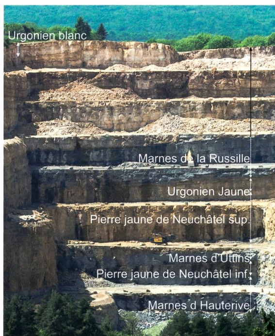
Figure 9. Lithostratigraphie sommaire de la carrière du Mormont près d'Éclépens en direction ouest, selon le Dr Antoine Pictet (image prise le 25 mai 2017).
