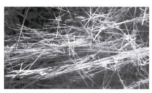
Figure 61. Calcite fibreuse photographiée au microscope électronique à balayage. Largeur de l'image 0.23 mm; route cantonale Vuitebœuf - Ste-Croix.
