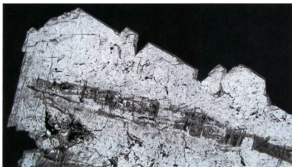
Figure 60. Coupe mince sagittale dans un agrégat de calcite à «âme». Les chapelets d'inclusions fluides apparaissent en gris foncé. Largeur de l'image 5 mm, Éclépens.
