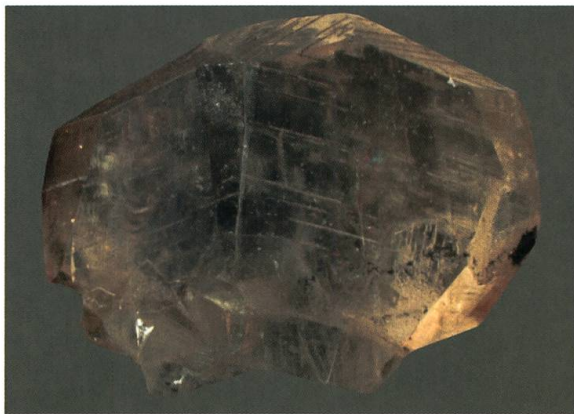
Figure 71. Calcite maclée selon (012). Les traces de clivages sont rendues bien visibles par la corrosion. Largeur du cristal 5 mm ; La Sarraz.
