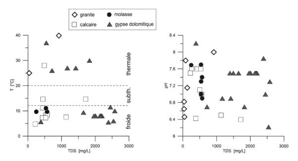
Figure 2. Température et pH en fonction de la charge totale dissoute (TDS).
