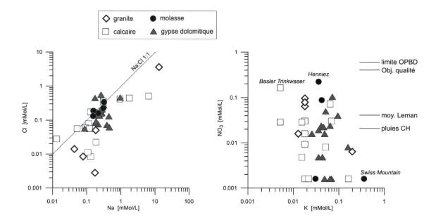
Figure 6. Concentrations en solution de Na vs Cl, et  $NO_3$  vs K. Limite OPBD = concentration maximale pour les eaux potables suisses (=40 mg/L). Obj. qualité = objectif de qualité défini dans le manuel suisse des denrées alimentaires (=25 mg/l).
