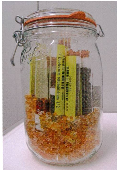
Illustration 5 : à gauche, un exemple de tubes scellés à la flamme où sont réparties les graines d'un lot. À droite, un bocal de conserve sert de deuxième enceinte étanche pour environ 18 tubes scellés posés sur un lit de silicagel.
