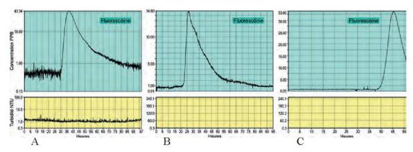
Figure 13.—Les courbes de restitution des trois traçages de 2012, soit: A) à la mare de Chillon; B) au lac de la Léchère; C) dans la grotte de la Mine. La courbe inférieure est celle de la turbidité. Pratiquement nulle, elle montre une eau limpide et calme (dépourvue de bulles d'air).
