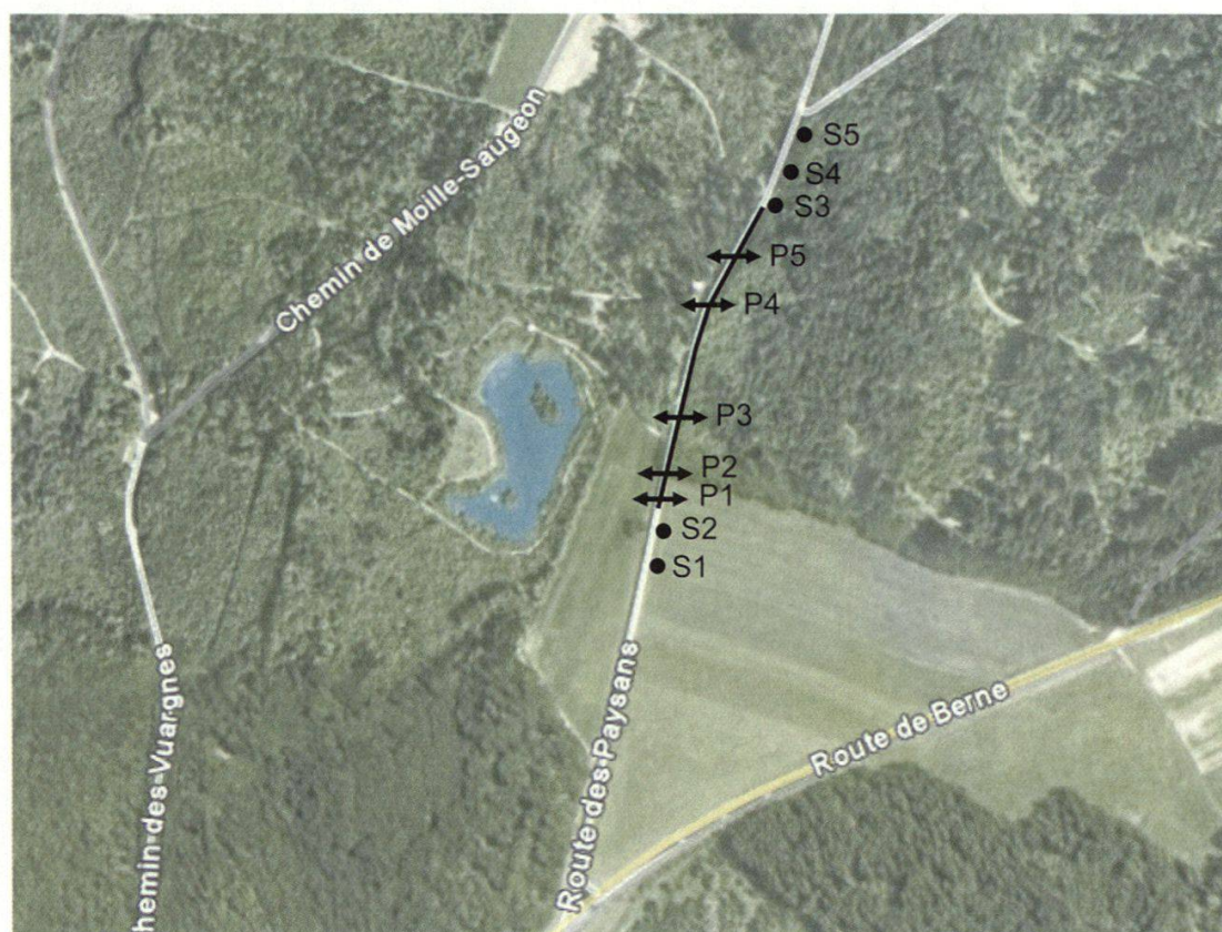
Figure 11.—Localisation des passages inférieurs (P) et des seaux aux extrémités des caniveaux (S). La ligne noire indique la position de l'installation permanente. Orthophotos © 2008 Tele Atlas via Google Earth.
