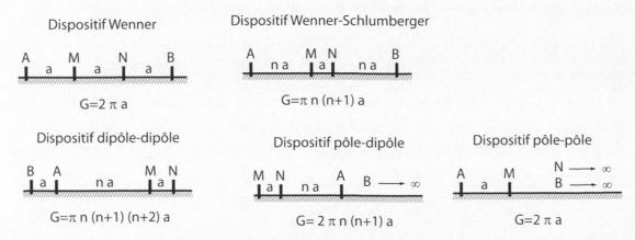
Figure 4.—Les différents dispositifs utilisés en imagerie électrique. A et B sont des électrodes d'injection de courant et M et N des électrodes de mesure du potentiel. The different electrode arrays used in electrical imaging. A and B are the current electrodes and M and N are the potential electrodes.
