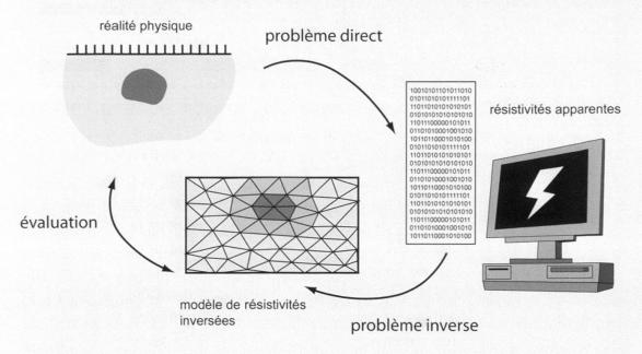
Figure 1.—Principe de l'imagerie électrique et définition du problème direct et du problème inverse.
