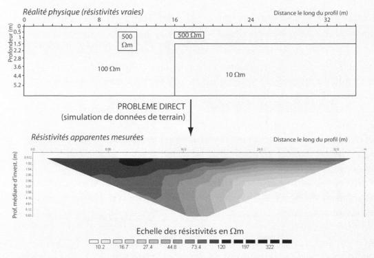
Figure 6.—Description du modèle utilisé pour synthétiser les données et panneau électrique des résistivités apparentes synthétisées.
