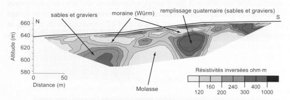
Dispositif Wenner-Schlumberger, 437 points de mesure, itération 4, erreur RMS: 3.9%
