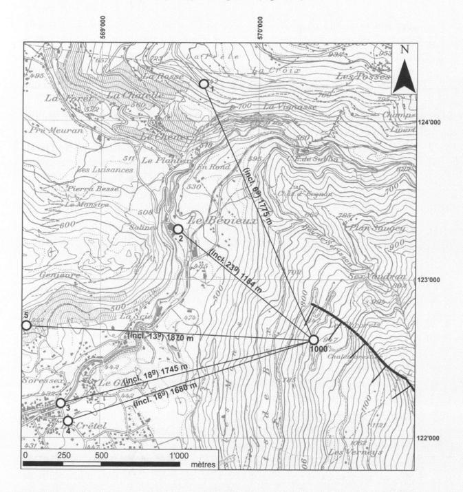
Figure 3.-Dispositif de contrôle du point 1000, les points 1 à 5 étant les points de visée.
