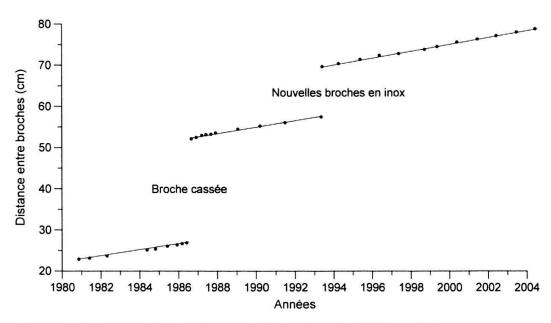
Figure 6.-Mesures de l'écartement de la fractures de 1981 à 2004.
