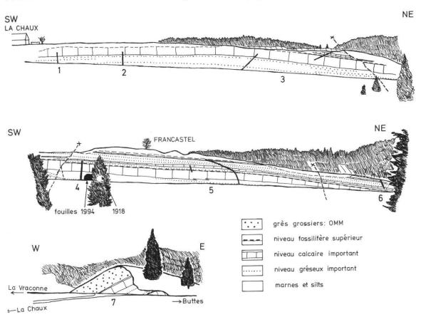
Figure 4.—Panorama géologique le long de la route descendant de La Chaux vers le carrefour du Miguet et Noirvaux-Dessus. Situation des profils étudiés (fig. 5) et position des fouilles 1918 et 1994. D'après des photographies prises en 1994.
