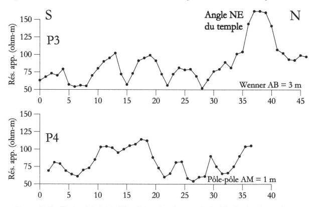
Figure 6.—Profils de résistivités P3 et P4, exécutés avant la fouille du chemin moderne N-S. Leur emplacement est donné à la figure 3.
