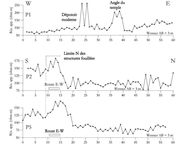
Figure 5.—Profils de résistivités P1, P2 et P5, exécutés avant les fouilles. Leur emplacement est donné à la figure 3.
