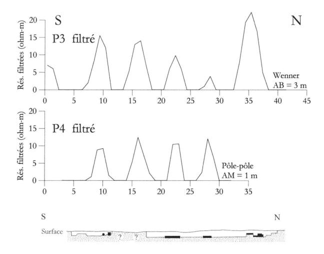
Figure 10.—Représentation des profils de résistivités filtrées P3 et P4 comparés avec les structures vues en coupe dans la fouille du chemin moderne N-S. Les pics du *signal detector* correspondent parfaitement au passage des murs ou des blocs calcaires.
