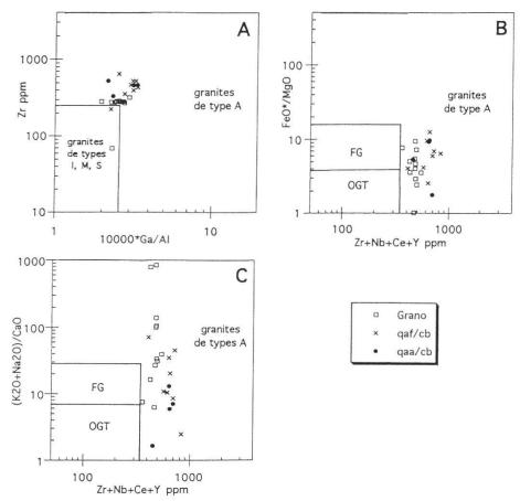
Figure 9.—Diagrammes discriminants pour les granites de type A, d'après Whalen *et al.* (1987). FG: granites felsiques fractionnés; OGT: granites de type I, S et M. Grano: granophyres; qaf/cb: roches non altérées du complexe bimodal: qaa/cb: roches altérées du Complexe bimodal.
