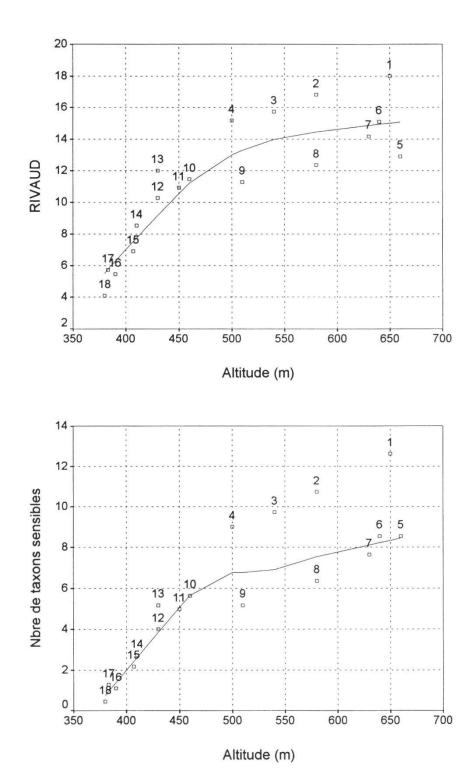
Figure 3.–Variations en fonction de l'altitude des stations de prélèvements des valeurs moyennes (1990 à 2000) de l'indice RIVAUD (figure du haut) et du nombre de taxons sensibles aux pollutions (figure du bas) dans le Veyron (stations 1 à 4: de Villars-Bozon à Ferreyres, voir figure 1) et la Venoge (stations 5 à 18: de L'Isle à Denges). Les courbes correspondent à des régressions robustes (LOWESS).
