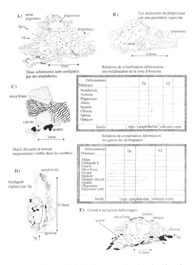
Figure 9.—Relations de cristallisation-déformation pour les métabasaltes et les gneiss. Dessins A, B et D=métabasaltes; C=marbre; E=gneiss.
