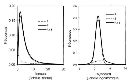
Figure 10.—Somme de deux distributions, A et B log-normales, représentées sur des échelles linéaire et logarithmique. Il faut surtout noter le déplacement du mode de la distribution B entre les deux échelles et le fait que la moyenne et la variance ne sont pas égales via le logarithme (ou l'exponentielle) d'une représentation à l'autre. L'exemple est volontairement particulier pour souligner l'effet du changement d'échelle.
