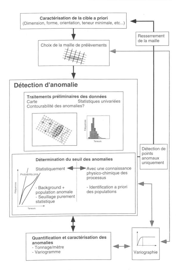
Figure 24.—Organigramme simplifié de la démarche menant à l'identification d'anomalies géochimiques essentiellement à l'aide d'outils statistiques univariés.
