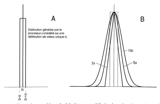
Figure 9.—Illustration graphique du théorème central limite. b est la valeur unique prise par l'ensemble des données avant que le phénomène n'affecte une fois (A) puis plusieurs fois (2×, 5× et 10×) (B) la distribution. Ceci est formellement égal à des produits de convolution successifs.
