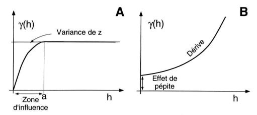
Figure 14.-En A schéma d'un variogramme stationnaire et en B variogramme non stationnaire avec effet de pépite.
