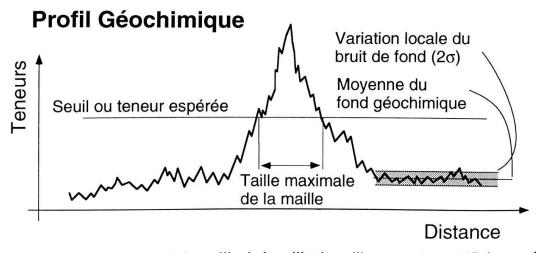
Figure 5.—Les dimensions de la maille de la grille de prélèvements sont définies par la forme, la taille et la teneur de l'anomalie à détecter. Ici le mot grille décrit aussi des profils.
