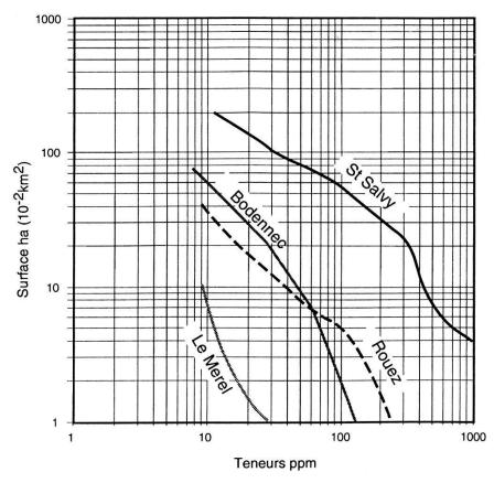
Figure 13.—Courbes de teneurs-surface en Pb pour quatre minéralisations sulfurées en France (d'après Barbier 1989). Les surfaces sont délimitées par les courbes isanomales. On observe que l'anomalie de St Salvy est toujours plus importante en tonnage que les autres. Par contre Rouez est une anomalie plus grande que Bodennec seulement à partir de 60 ppm.
