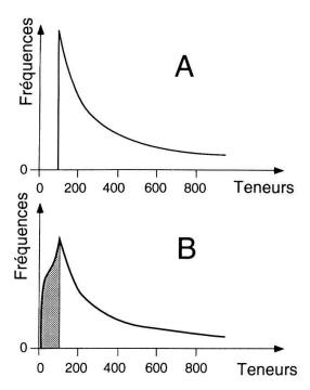
Figure 7.—Effet de la forme du support sur la distribution des teneurs d'une anomalie générée par un processus de diffusion, échantillonnée de façon homogène, en A sur un support circulaire et carré en B. L'effet se voit sur les faibles teneurs (grisé). Une distribution des teneurs produites uniquement par diffusion est inversement proportionnelle à la teneur en échelle linéaire (JABOYEDOFF and MAIGNAN in prep.)
