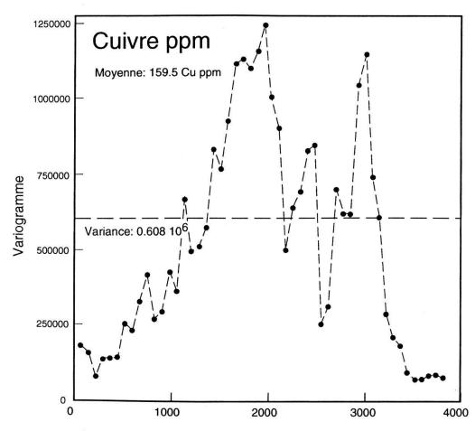
Figure 20.–Variogramme des données de la figure 15. La direction de recherche est celle des profils  $\pm 5^{\circ}$  et le pas de h est de 75 m  $\pm 10$ m.
