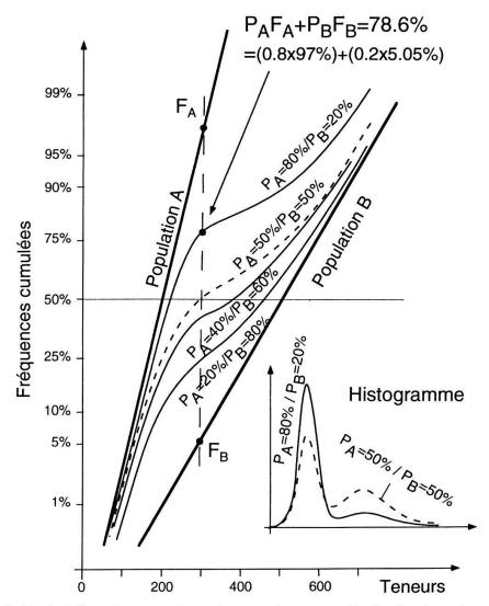
Figure 12.—Probability plot normal représentant la somme de distributions dont on a fait varier le poids. En petit, histogrammes de deux de ces courbes. Les points de plus forte courbure ou les points d'inflexion indiquent à peu près le poids des deux distributions.
