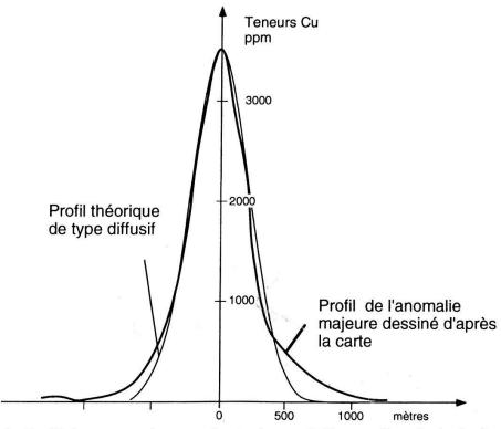
Figure 19.—Profil des teneurs à travers le maximum de l'anomalie principale. La courbe a été établie à partir de la carte (lissage) et parallèlement au profil. Le profil théorique est très proche de celui de l'anomalie. Notons qu'une moyenne mobile sur les teneurs brutes donne un résultat tout à fait similaire.
