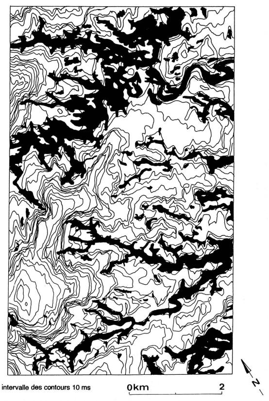
Figure 2.—Paléomorphologie d'une surface érosive messinienne au large du delta de l'Ebre (Espagne). Mise en évidence de faciès sismiques similaires dans les dépressions, interprétés comme remplissages fluviatiles (contours de profondeur-temps en millisecondes).
