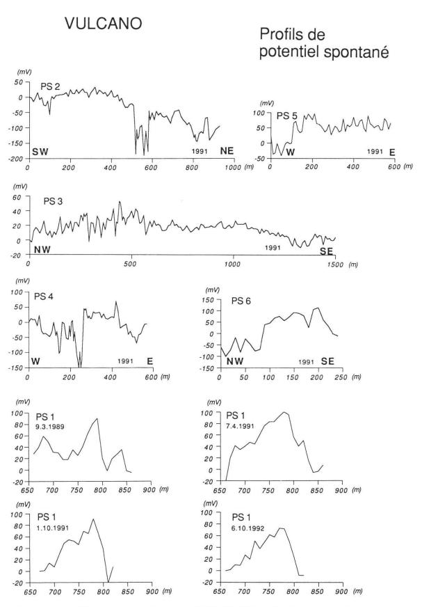
Figure 4.—Profils de potentiel spontané PS 2 à PS 6. Evolution dans le temps de l'anomalie positive centrale de PS 1; les valeurs d'abscisses sont compatibles avec celles du profil complet du haut de la figure 3.
