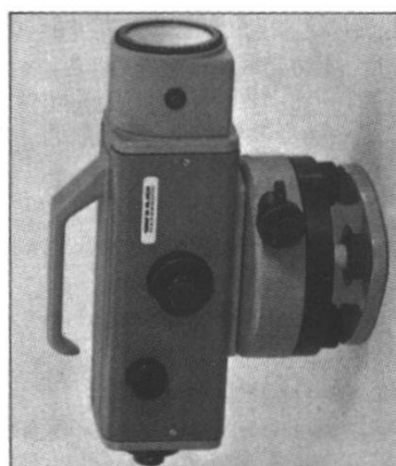
Figure 9.—Le niveau de précision WILD N3, l'un des plus précis sur le marché; il est caractérisé par une erreur moyenne de \pm 0.2 mm pour un cheminement aller-retour de 1 km.
