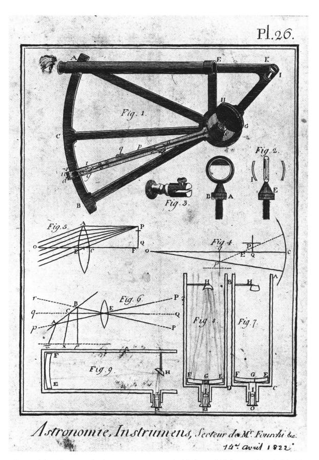
Figure 13.— «Astronomie, instrumens, secteur de Mr Fourchi [sic pour Fouchy?], 14 avril 1822». Planche gravée, intégrée aux papiers d'Adrien Pichard, montrant un instrument à réflexion (MHL).
