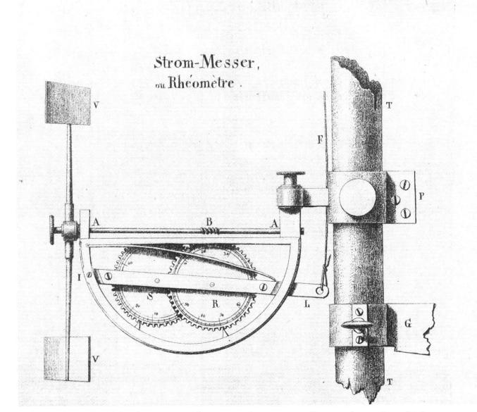
Figure 5.—Rhéomètre, «appareil peu ou point connu en France», inventé par Woltmann en 1790 et gravé d'après un dessin de Wollmar, «fils du peintre célèbre de ce nom, et l'un des élèves les plus distingués de l'Ecole du génie de Berne». Ulrich Schenk s'apprête à le construire (*Bibliothèque universelle* t. 6, 1817).
