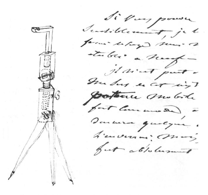
Figure 10.—Trépied à potence pour niveau à pendule. Esquisse envoyée par Adrien Pichard à Jacob Kern en 1837 (ACV, P Pichard, P 145 bis).
