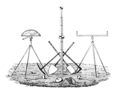
Figure 1.—Les instruments de l'ingénieur: notamment, sur pied, le graphomètre, la mire et le niveau à eau; au sol, la chevillière et la chaîne d'arpenteur. Vignette sur papier à lettre de Justin-Louis Guex, ing., en tête d'une missive datée du 13 octobre 1852 et relative au tracé de la route d'Oron à Jongny (ACV, K IX 1149/307).
