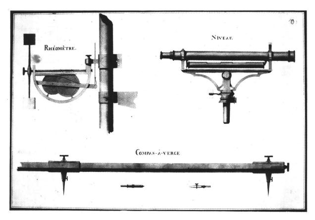
Figure 8.—Rhéomètre, niveau à bulle et compas à verge, dessinés en 1820 par Joseph de Raemy, alors en formation en Suisse alémanique, avant de devenir élève de l'ingénieur Pichard (AE Fribourg).
