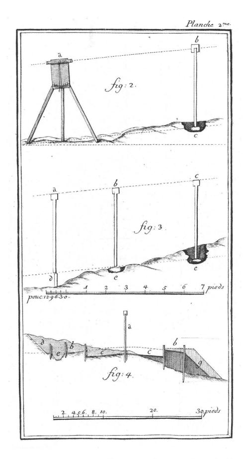
Figure 3.-«Kliseomètre», soit appareil à mesurer les pentes du terrain (EXCHAQUET 1787, pl. 2).
