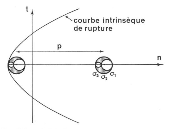
Figure 17.–Fracturation hydraulique.
