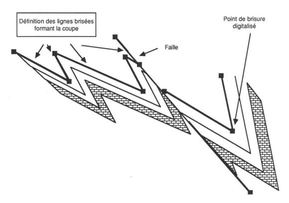
Figure 2.-Digitalisation d'une coupe. Les points de brisure de chaque ligne sont mis en mémoire.
