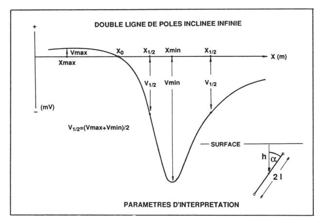
Figure 5.-Modèle d'anomalie théorique. L'aplomb du centre de la structure se trouve entre  $V_0$  et  $V_{min}$ .
