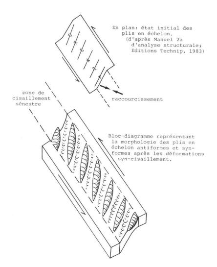
Figure 5.—Genèse des plis en échelon à l'intérieur d'une zone de cisaillement sénestre
