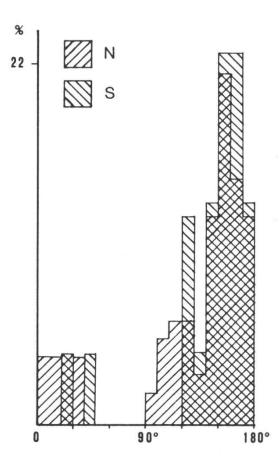
Figure 5. – Histogramme de la répartition des fractures verticales au S et au N de la Cornieule supérieure.
