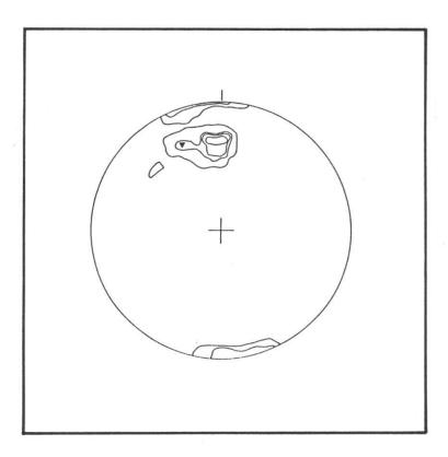
Figure 4. – Orientation du clivage dans le flanc inverse du synclinal de Leysin. ( $\nabla$  = orientation moyenne de la stratification). Courbes d'isodensité: 4%, 10%, 18%, 23%, n = 90. (Canevas de Schmidt, hém. inf., pôles des surfaces).
