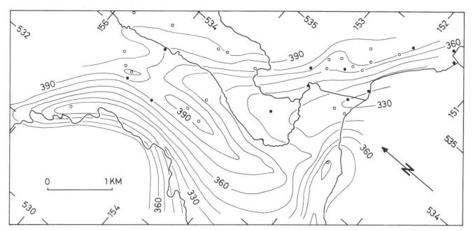
Figure 4. – Carte structurale du toit de la Molasse entre Flon et Venoge. Equidistance des courbes: 10 m. Cercle vide: sondage atteignant la Molasse. Cercle plein: sondage profond resté dans le Quaternaire. Les sondages du secteur de l'EPF-L (fig. 5) n'ont pas été reportés.
