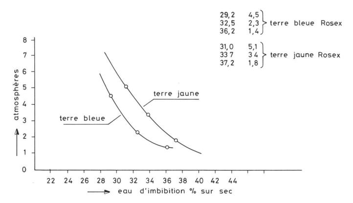
Figure 11. – Pression nécessaire à provoquer le début de l'écoulement plastique au travers d'une filière pour différentes teneurs en eau d'imbibition (terres jaunes et bleues de la région de Rosex).
