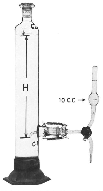
Figure 12. – Cylindre utilisé pour la détermination de la granulométrie par sédimentation.
