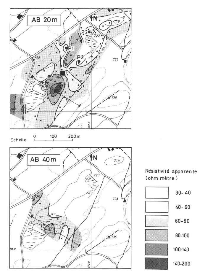
• P13 Implantation des pénetromètres 1 à 3
