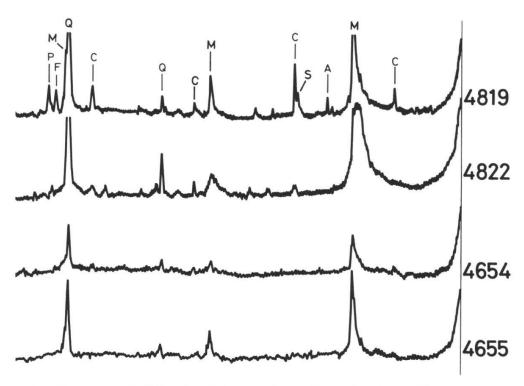
Figure 2. – Diagrammes de diffraction X des matériaux suivants, fractions <20  $\mu$ m: 4819 et 4822: horizons A01 et A 12 du sol 81.
