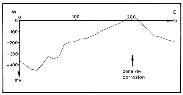
Fig. 6. - Corrosion d'une conduite par les courants spontanés.
