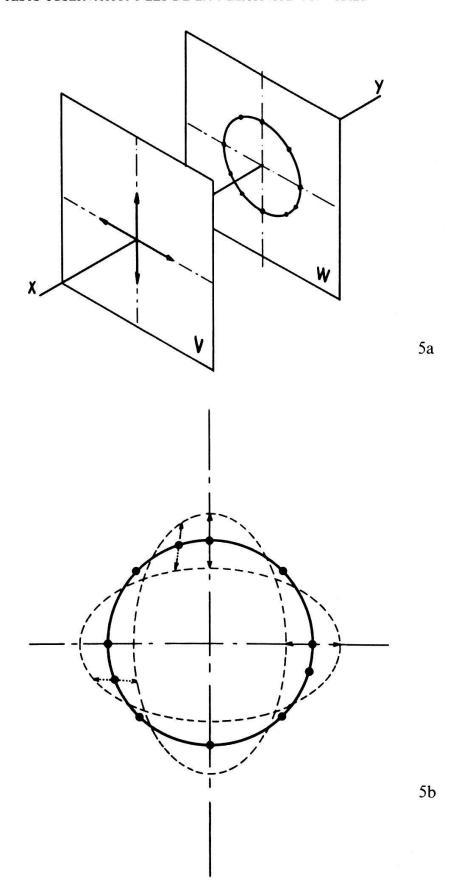
Fig. 5. – 5a. Onde gravitationnelle dont la vibration s'opère dans le plan V et se propage dans la direction XY. Des objets matériels symétriquement disposés sur un cercle dans un plan W parallèle à V vont, une fois atteints par l'onde, subir une double vibration illustrée en 5b.
