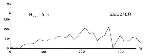
Fig. 7. - Anomalie positive à l'aval du barrage de Zeuzier vide.
