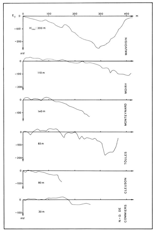
Fig. 2. - Profils de potentiels à l'aval des barrages.
