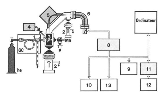
Fig. 1. — Schéma d'un chromatographe en phase gazeuse couplé à un spectromètre de masse (GC-MS-COM) (d'après Varian MAT 112).
