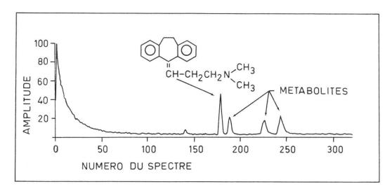
Fig. 4. — Chromatogramme reconstitué par ordinateur du flux total ionique provenant de l'injection d'un extrait d'urine d'un patient qui a reçu une dose d'amitriptyline. D'après Foltz et coll. (1974).
