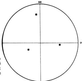
Fig. 7. — Projection stéréographique de l'orientation d'un grain recristallisé (pôles du type <001>) par rapport aux directions DD et DT de la matrice écrouie.
