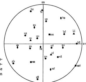
Fig. 6 bis. — Projection stéréographique de l'orientation des monocristaux par rapport à la direction de déformation DD et à la direction transverse DT
