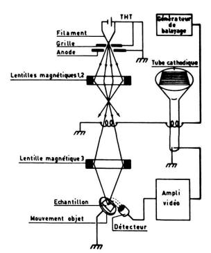
Fig. 1. — Microscope électronique à balayage (schéma de principe).
