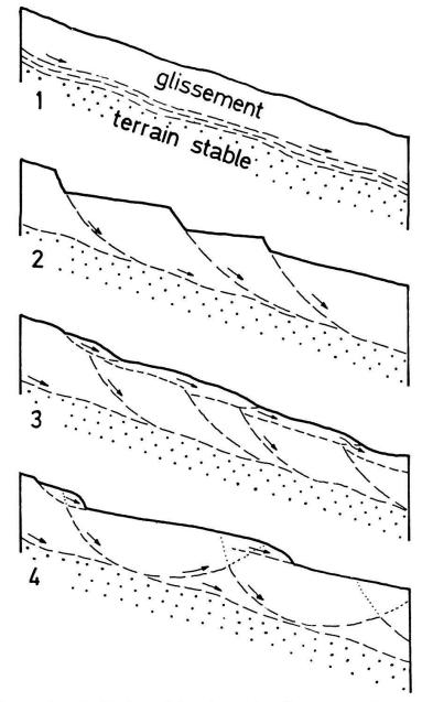
Fig. 4. — Coupes longitudinales schématiques des divers types de mouvements dans un glissement. Voir le texte.
