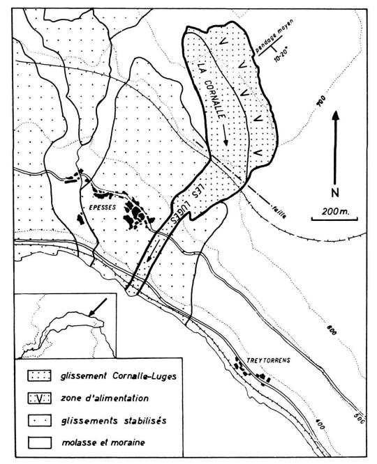
Fig. 1. — Situation topographique et géologique. Afin de ne pas surcharger le dessin, on n'a pas figuré le tracé de l'autoroute N 9.
