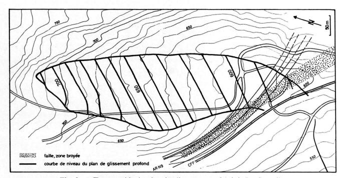
Fig. 3. — Topographie du plan de glissement profond de La Cornalle.
