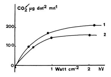
Fig. 3. — Variation de l'activité photosynthétique (CO<sub>2</sub> ) en fonction des différents niveaux d'énergie lumineuse (hv), chez la 3e feuille apparue ayant subi une fumigation de 3 minutes par 2,5 ppm de SO<sub>2</sub> (1) et n'ayant pas subi de fumigation (2). Chaque point est la moyenne de mesures faites sur 10 feuilles issues de plantes différentes.
