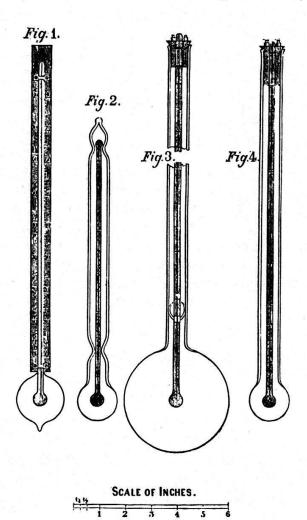
Fig. 2. — « Thermomètres de passage » de Rumford, pour mesurer la transmission de la chaleur à travers le vide (1) ou diverses substances introduites dans l'espace entourant le réservoir (2, 3, 4). Chaque essai est répété avec le même espace contenant de l'air. On compare les temps de refroidissement. (Count Rumford, Complete Works, v. I, p. 404-405, Boston, 1870)
