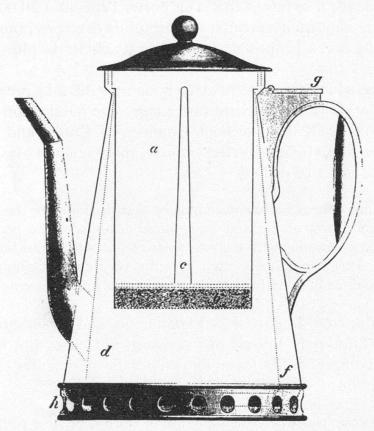
Fig. 1. — Dessin d'une cafetière que l'enveloppe f, partiellement remplie d'eau, permet de chauffer sans risque de faire cuire le café filtrant de b. (Count Rumford, Complete Works, v. IV, p. 642, Boston 1875.)
