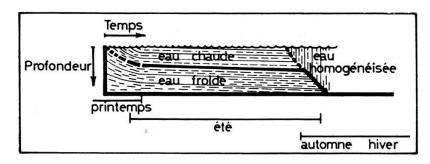
Fig. 4. — Schéma des variations mensuelles de la température de l'eau du lac.
