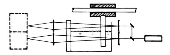
D'autres méthodes peuvent être préconisées pour la mesure des chemins optiques dans le milieu liquide. Par exemple, l'emploi de lumière polarisée circulant dans un interféromètre du type de Mach-Zehender.
