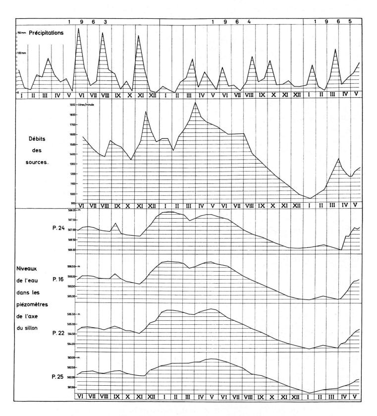
Fig. 4. — Précipitations, débits et variations des niveaux piézométriques.
