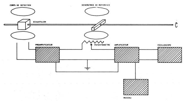
Fig. 1. — Schéma du magnétomètre rotatif
