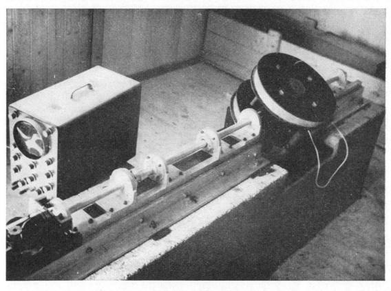
Fig. 2. — On remarquera sur cette photographie : à droite le corps de détection au centre l'axe de rotation à gauche la génératrice de référence
