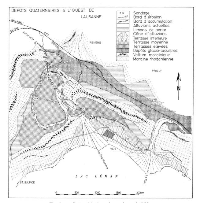
Fig. 1. — Carte géologique des environs de Vidy. Surface hachurée à l'est de la Chamberonne au sud de l'autoroute : chantier de la Station d'épuration des eaux usées de la Ville de Lausanne.
