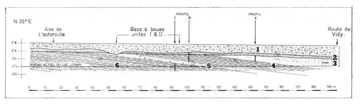
Fig. 2. — Coupe géologique du chantier de la Station d'épuration des eaux de Lausanne.
