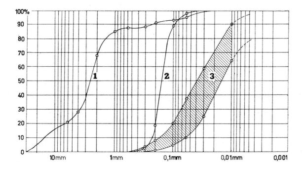
Fig. 4. — Courbes granulométriques des sédiments des couches 2, 5 et 6.
