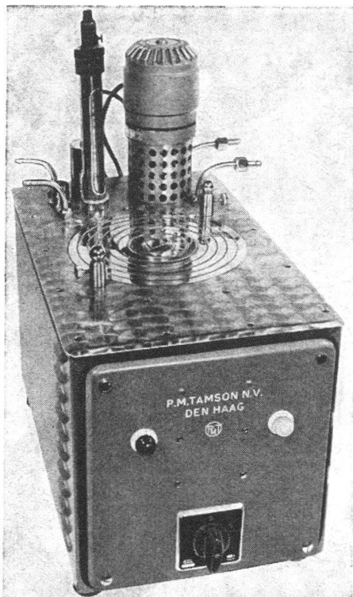
Exactitude et constance de température inégalées, jusqu'à  $\pm 0,002^\circ\text{C}$
