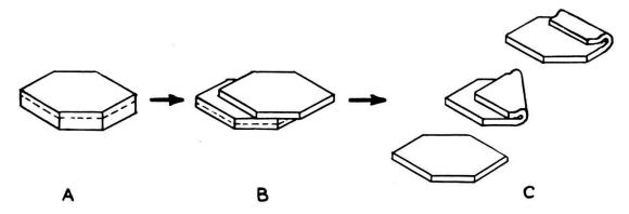
Fig. 3. — Schéma d'altération de la kaolinite par l'eau pure Figure extraite d'un article de A. OBERLIN et C. TCHOUBAR, paru dans la revue Silicates industriels, publiée avec l'aimable autorisation des auteurs.
