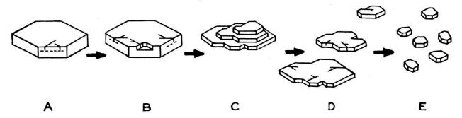
Fig. 4. — Schéma d'altération de la kaolinite par une eau magnésienne Figure extraite d'un article de A. Oberlin et C. Tchoubar, paru dans la revue Silicates industriels, publiée avec l'aimable autorisation des auteurs.
