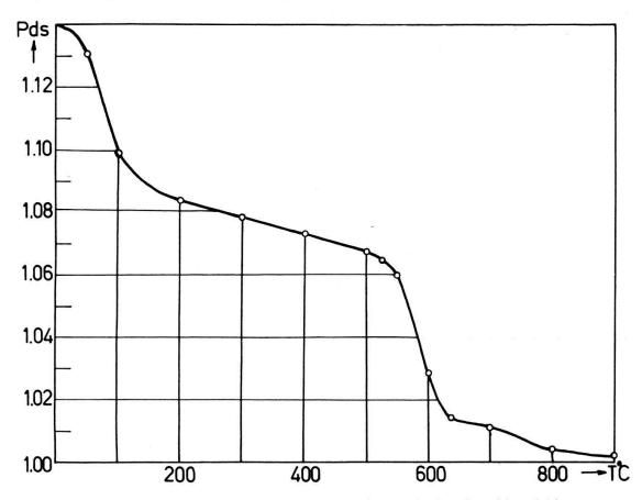
Fig. 2. — Courbe d'analyse thermo-pondérale de l'argile sidérolithique du Mormont
