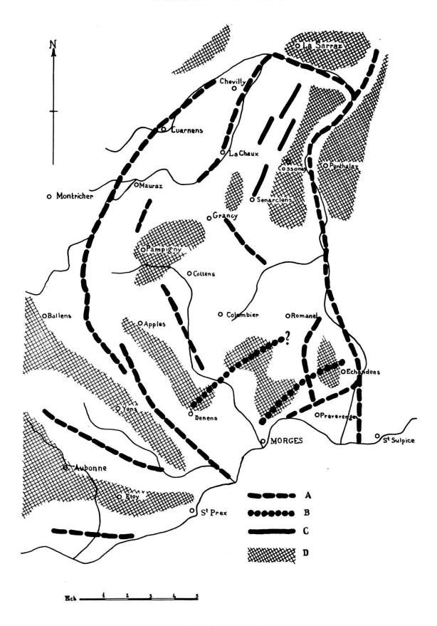
Fig. 1. — Interprétation schématique des anomalies dues au Quaternaire dans la région nord de Morges. A = alluvions et fluvio-glaciaire; B = axe des anticlinaux; C = vallums et drumlins (de grande taille); D = zones «lourdes», à couverture Quaternaire de faible épaisseur
