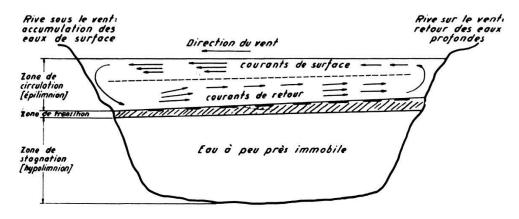
Fig. 3. — Représentation schématique des courants internes dans un lac stratifié soumis à l'action du vent
