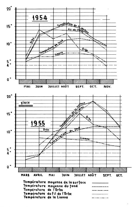
Fig. 4. — Lac de Joux: Températures moyennes du fond et de la surface. Températures de l'Orbe au pont des Crêtets, du Fil de l'Orbe (850 m NE de l'embouchure de l'Orbe), et de la Lionne au pont vers la fabrique de limes de L'Abbaye
