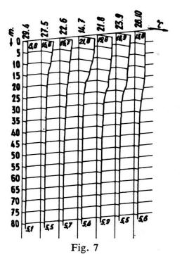
Ainsi, dans le lac de Neuchâtel, d'une profondeur maximum de 154 m, les sondages thermométriques exécutés mensuellement de mai 1957 à octobre 1959 à la station N, où la profondeur atteint 82 m, indiquent de faibles fluctuations de la température de la zone profonde du haut lac; l'amplitude de la variation annuelle oscille entre 0,8° et 1,4° (fig. 5-7).
