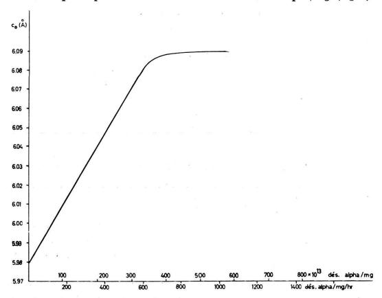
Fig. 1. — Relation liant c<sub>0</sub> au taux d'irradiation (en désintégrations alpha/mg) et à l'activité spécifique alpha (en désintégrations alpha/mg/heure) pour les zircons de Ceylan âgés de 550 millions d'années.
