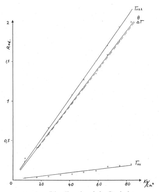
Fig. 1. — Effet piézooptique de la silice fondue.
