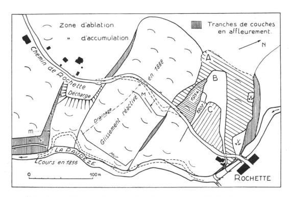
Fig. 1. — Plan de la zone de glissements de Rochette, avec emplacement des plaques A, B, C et des glissements de 1888, 1907 et 1954. Voir légende fig. 2.
